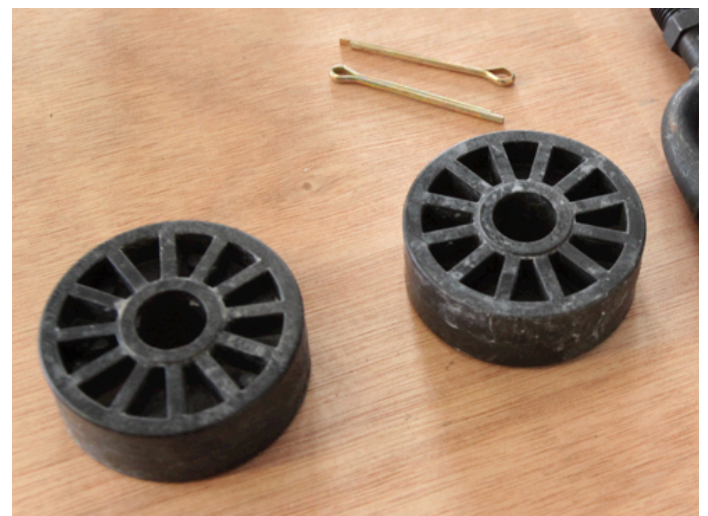
Bedienpulträder mit Sicherungsstiften
