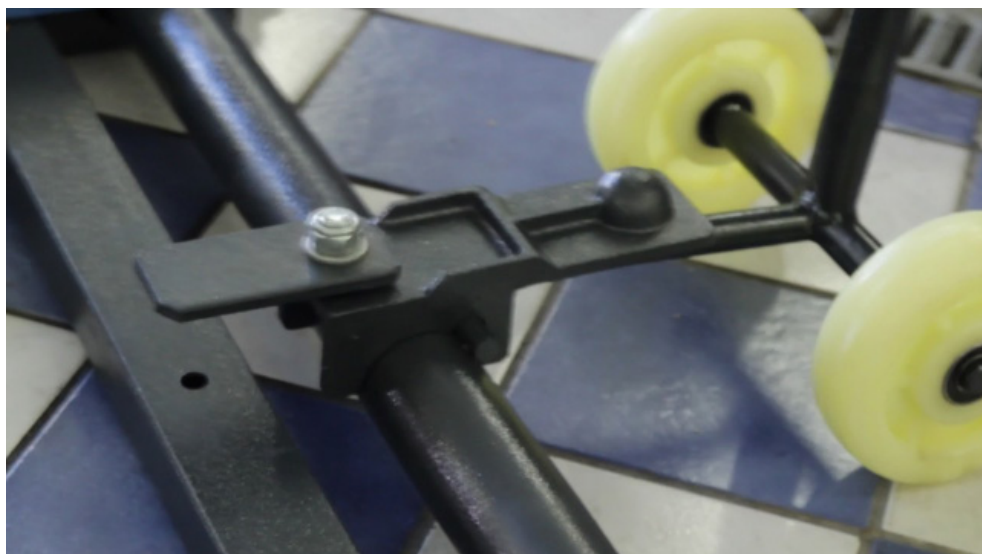
Einhaken der Fahrwerkskupplung
