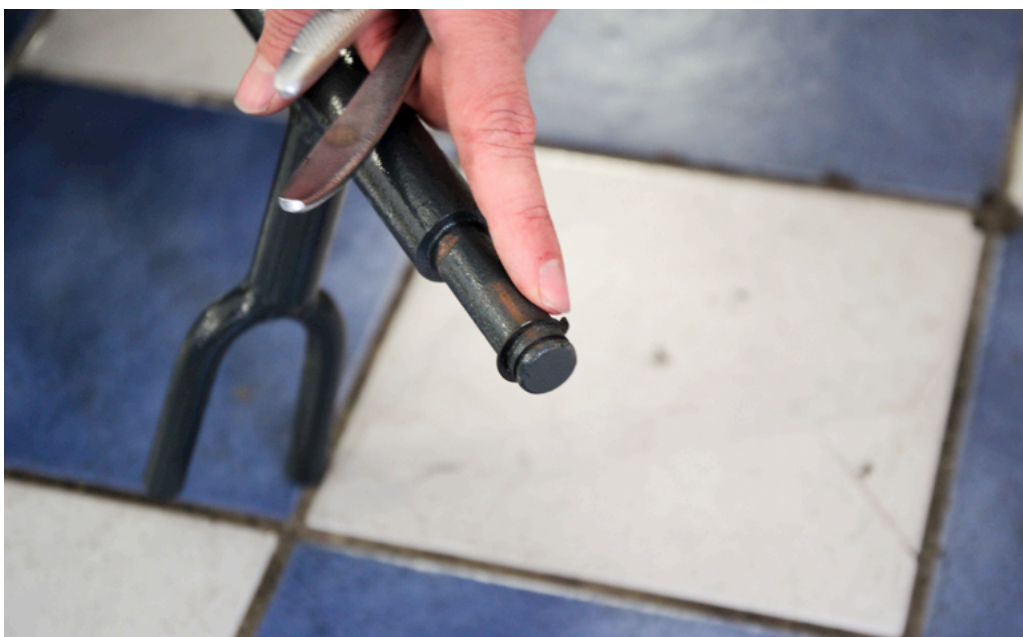
Position des Sicherungsrings nach der Rollenmontage.
