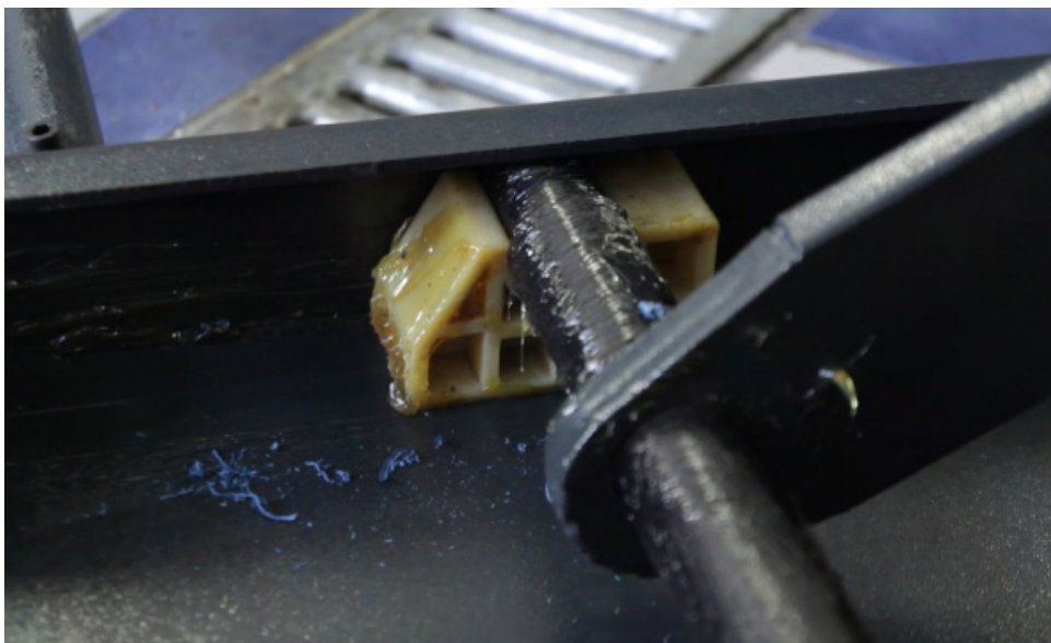
Auch diese Schiene muss geschmiert sein.
