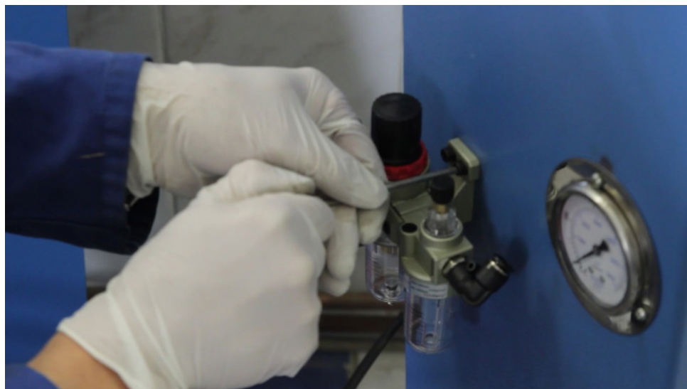
Anschrauben des Druckminderers.
