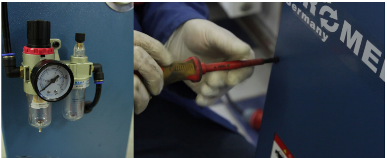
Öffnen des Bedienpultes und Druckminderer.
